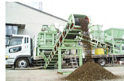
TM1000 (自走型) 特殊条件(試験施工等)向けプラント 【処理能力】110m³/日
