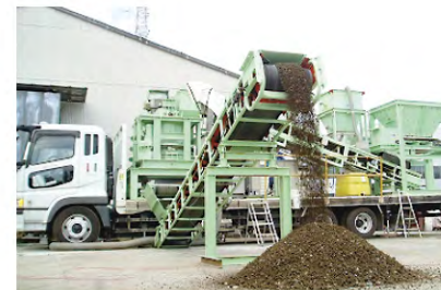
TM1000 (自走型) 特殊条件(試験施工等)向けプラント 【処理能力】110m 3 /日
