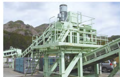
TM1500 中規模工事向けプラント 【処理能力】500m 3 /日
