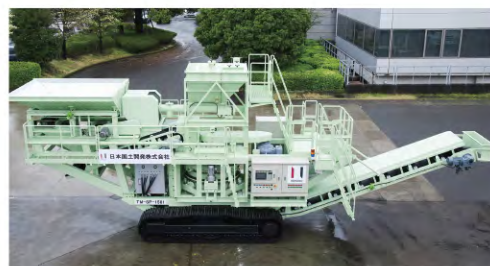
TMSP1500 (自走型) 特殊条件(狭陰ヤード等)向けプラント 【処理能力】300m³/日
