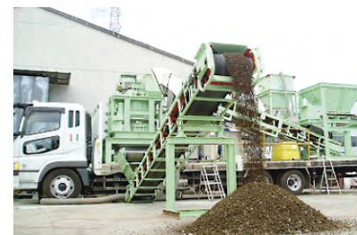
TM1000 (自走型) 特殊条件(試験施工等)向けプラント 【処理能力】110m³/日
