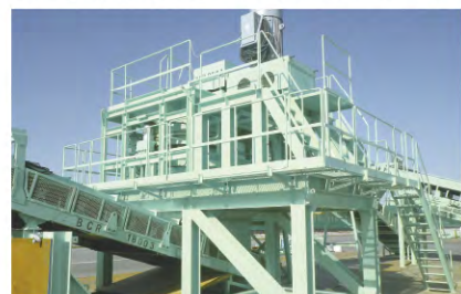
TM2250 大規模工事向けプラント 【処理能力】強化型 1,500m³/日・標準型 1,000m³/日
